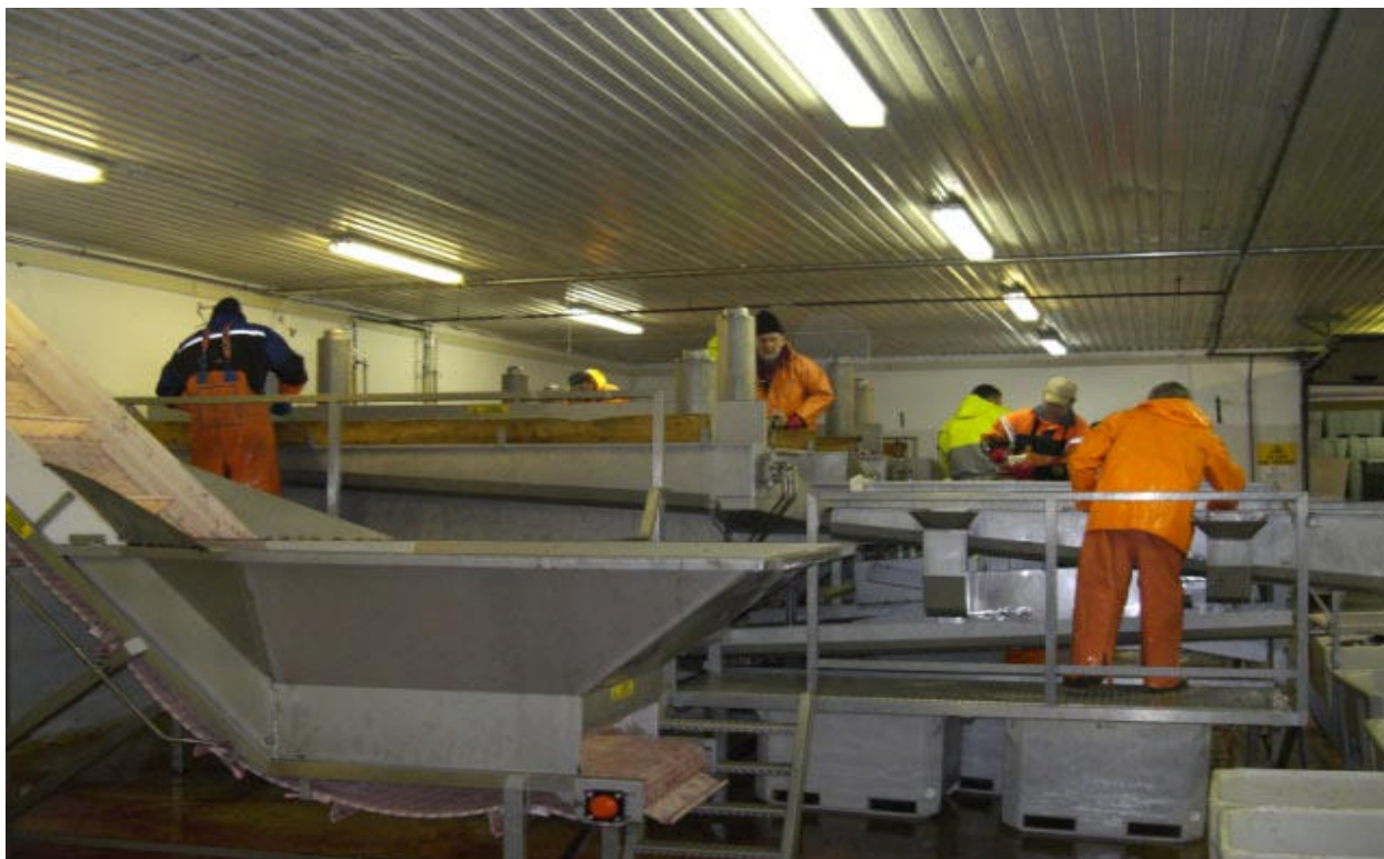
Inntaksbrønn på linjen. Kontainere tippes i brønnen
